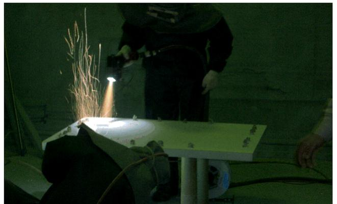
【ゴム支承の金属部分への溶射】
