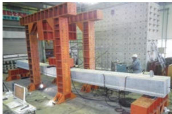
JIS桁による耐荷力および力学特性の確認
