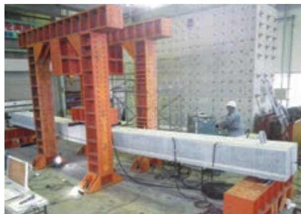
JIS桁による耐荷力および力学特性の確認
