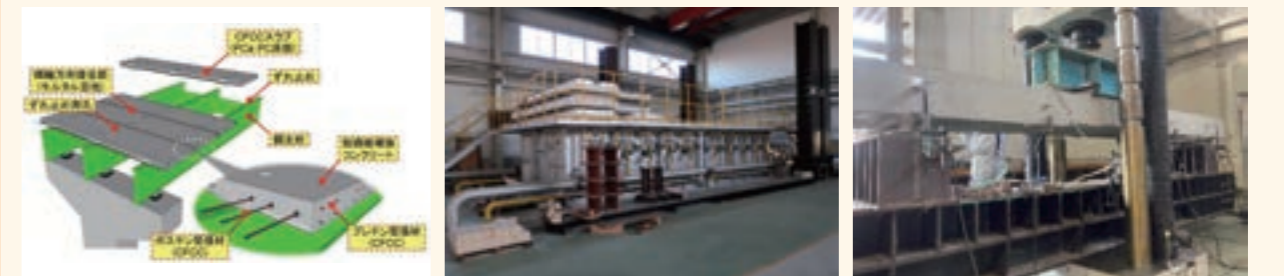
CFCCスラブの概要 大型水平加熱炉（大阪工業大学八幡工学実験場）被災したCFCCスラブの耐荷性能評価
