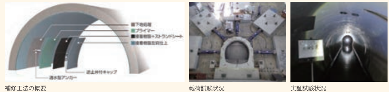
補修工法の概要 荷重試験状況 実証試験状況
