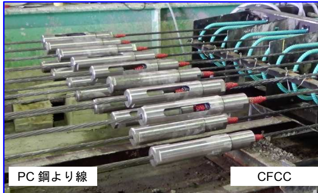
【PC 工場のプレテンラインでの PC 鋼線との接続例】
