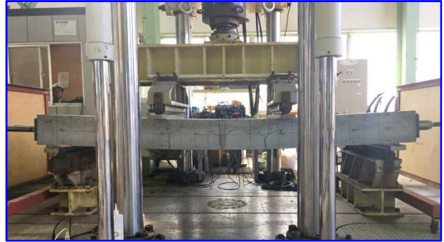
【静的曲げ破壊試験の概要】
