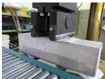
● ひび割れ含浸試験
