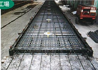
1.PC鋼材及び鉄筋配置
