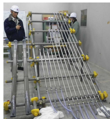
内径 3mm の傾斜管試験(右から 3本ずつ長さ 3m、2m、1m)
