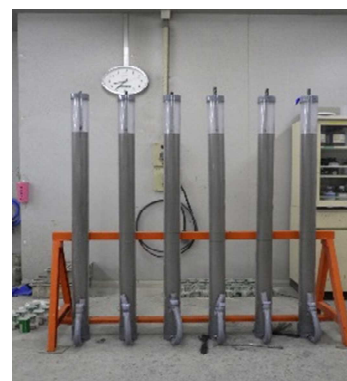
鉛直管試験(体積変化率・ ブリーディング率の測定)
